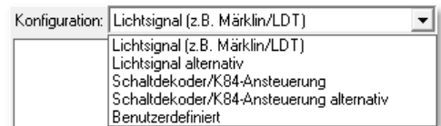
Abb. 5.57 Verschiedene Ansteuerungen für Signale (4-begriffig)
