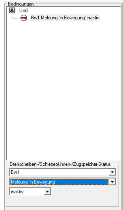
Abb. 13.38 Die Bedingung „Drehscheibe /Schiebebühne/Zugspeicher-Status“
