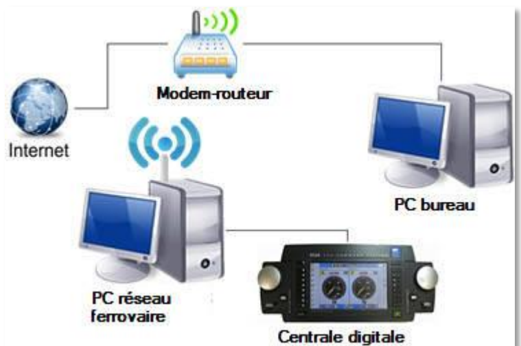
Fig. 3.6 Deux réseaux; le PC réseau ferroviaire avec connexion Wifi pour Internet
