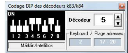
Fig. 5.59 Commutateur DIP pour k83/k84
