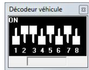
Fig. 4.16 Représentation des micro-interrupteurs d'une loco Märklin
