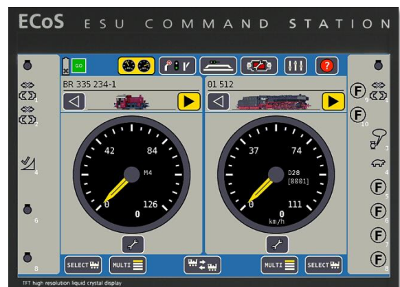
Fig. 4.67 La locomotive mfx après la reconnaissance
