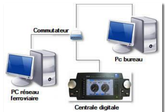
Fig. 3.4 Réseau avec plusieurs clients et un commutateur
