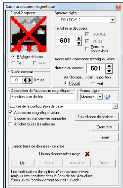
Fig. 5.49 Un commutateur virtuel commande un contact de rétrosignalisation
