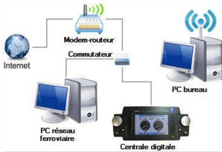
Fig. 3.5 Réseau avec connexion Internet
