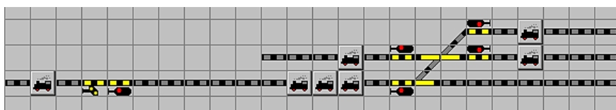
Fig. 3.133 Différents placements des étiquettes de suivi de train dans l'éditeur de plan de voies
