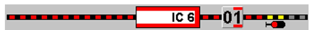
Fig. 4.14 Adresse digitale et nom du train dans les étiquettes de suivi de train
