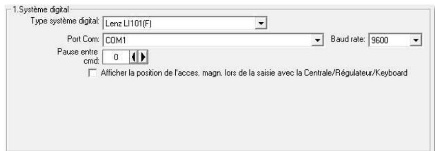
Fig. 3.47 Paramètres pour les interfaces Lenz LI100(F) et LI101(F) (ici le: LI101(F))
