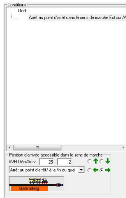
Fig. 9.8 La condition position d'arrivée accessible sur AVH
